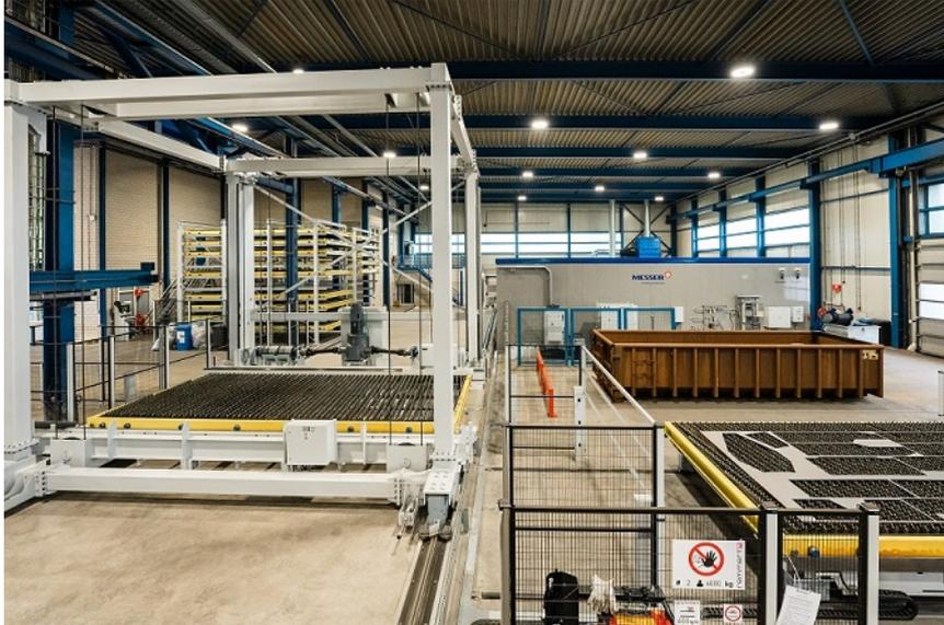
Foto 8: Die Softwaresuite OmniFab verbindet die verschiedenen Softwaresysteme, Schneidmaschinen sowie das Remmert Material Handling System über verschiedene Schnittstellen. © Messer Cutting Systems
