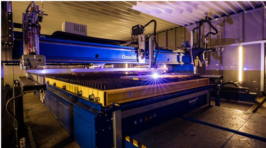
Foto 6: Die OmniMat®-Schneidmaschine ist mit dem Skew Delta Plasma-Fasenaggregat zur Schweißnahtvorbereitung ausgestattet. © Messer Cutting Systems
