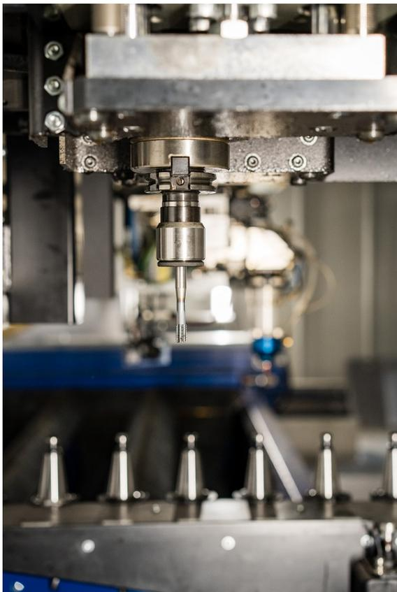
Foto 7 oder 7b: Beide Maschinen sind mit einer Bohreinheit inklusive 24-fach Werkzeugwechsler ausgestattet. © Messer Cutting Systems
