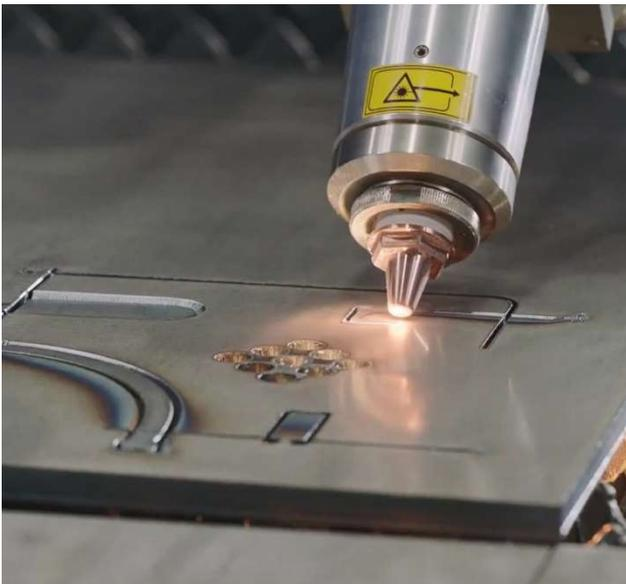
Foto 1: Das neue hochdynamische Laserfasenaggregat Bevel-U ermöglicht die Herstellung präziser und wiederholgenauer Fasenteile - ein großer Vorteil bei der Kantenvorbereitung für automatisiertes Roboterschweißen.
