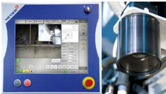
Die Videokamera (rechts) ermöglicht eine schnelle und präzise Blechlagenkompensation.
