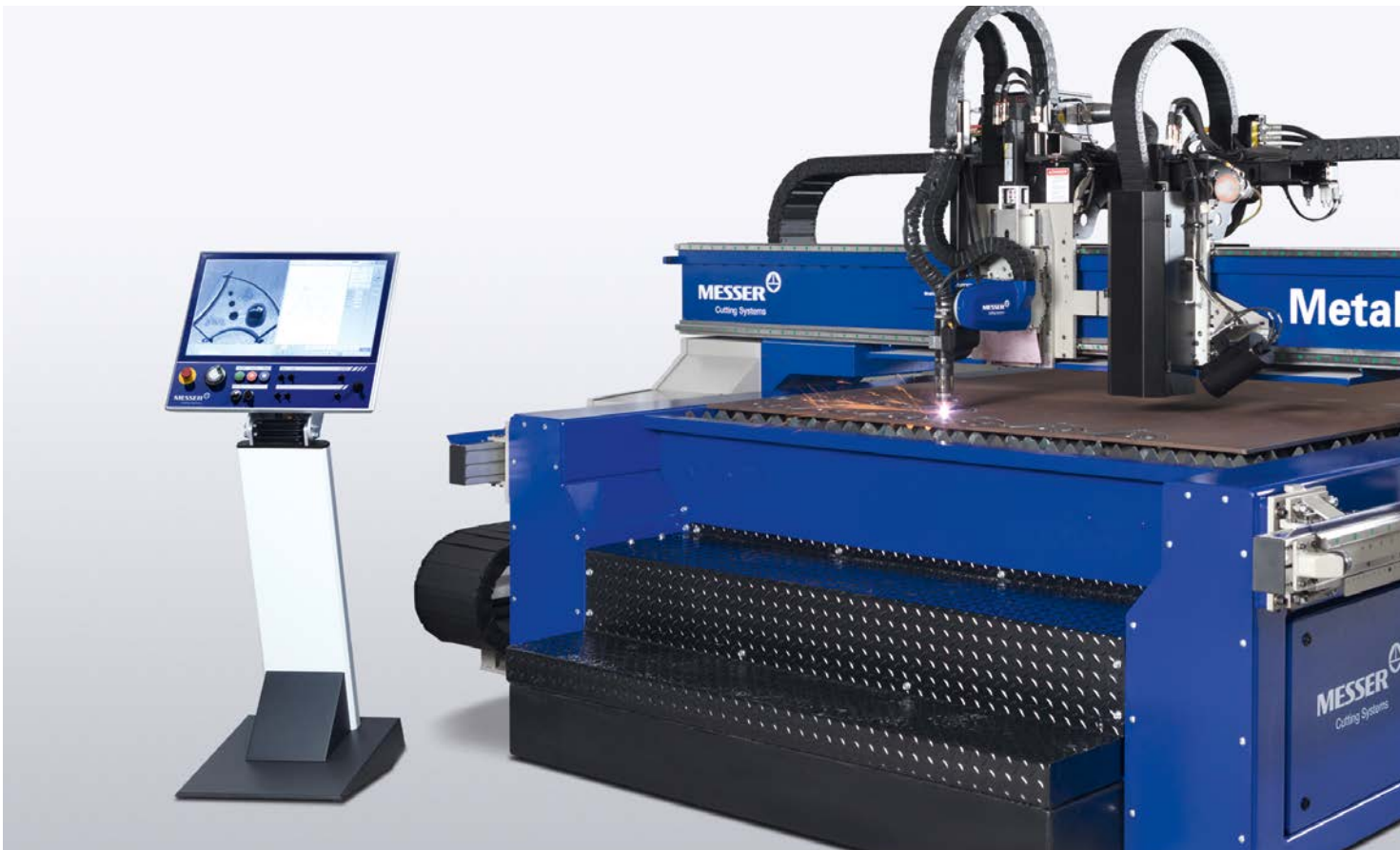
Bedienerfreundliche 24" CNC Steuerung Global Control für schnelle und einfache Einstellungen.
