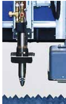
Nadelmarkierer OmniScript Trägt Schriften, Linien und permanent auf die Bauteile.
