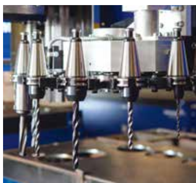
Der Bohrer mit mehrfachem Werkzeug- wechsler erzeugt präzise Löcher und schneidet Gewinde.
