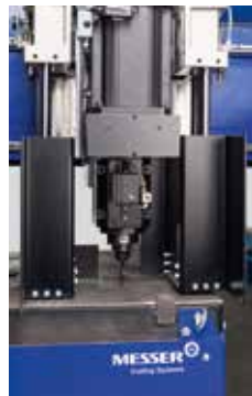
Bohren, Aufbohren, Senkenschneiden als zusätzliche verfahren
