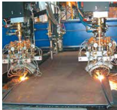
Das 3-Brenner-Fasenschneidaggregat DAFL ist das ideale Werkzeug zum Schneiden von Windturmblechen
