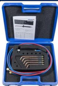
Bestehend aus MINITHERM-Griffstück mit eingebundenen Schläuchen, Länge 3m, Anschlüsse G1/4"RH für Sauerstoff und G3/8"LH für Brenngas und fünf Einsätzen Typ A Gr. 00 bis 3 im Kunststoffkoffer.
