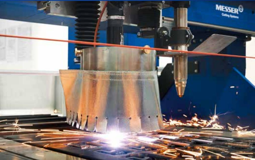
Sie lernen, wie man autogen oder mit Plasma mit einfachen Senkrechtschnitten Werkstücke auf einer CNC-gesteuerten Maschine ausschneidet.
