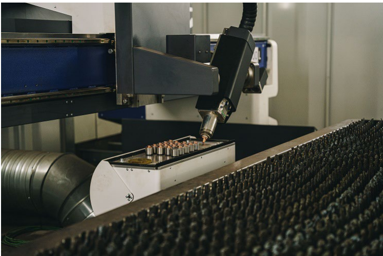
Bild 2: Ein Feature für die Automation der ELEMENT 400 L ist der Düsenwechsler (LNC). Er automatisiert schnell und zuverlässig die Einrichtarbeiten und sorgt so für maximale Produktivität und Qualität. © Messer Cutting Systems
