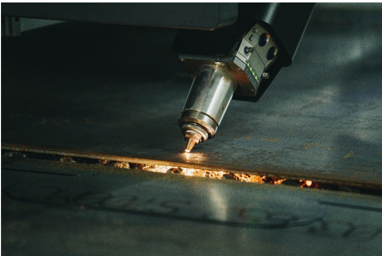
Bild 9: Das neue hochdynamische Laserfasenaggregat Bevel-U ermöglicht die Herstellung präziser und wiederholgenauer Fasenteile – ein großer Vorteil bei der Kantenvorbereitung für automatisiertes Roboterschweißen. © Messer Cutting Systems
