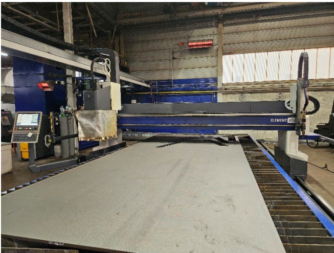
Bild 1: Brennschneidmaschine ELEMENT mit Plasma-Fasenaggregat Bevel-S und Autogenbrenner ALFA von Messer Cutting Systems.
