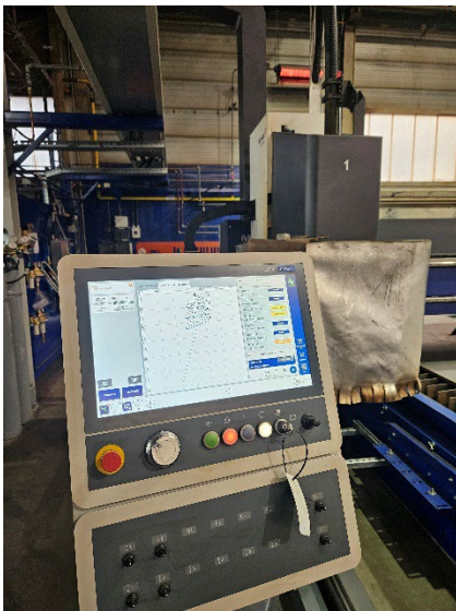
Bild 3: Benutzerfreundliche Global Connect-Steuerung mit Schachtelplan aus der OmniWin CAD/CAM Software.
