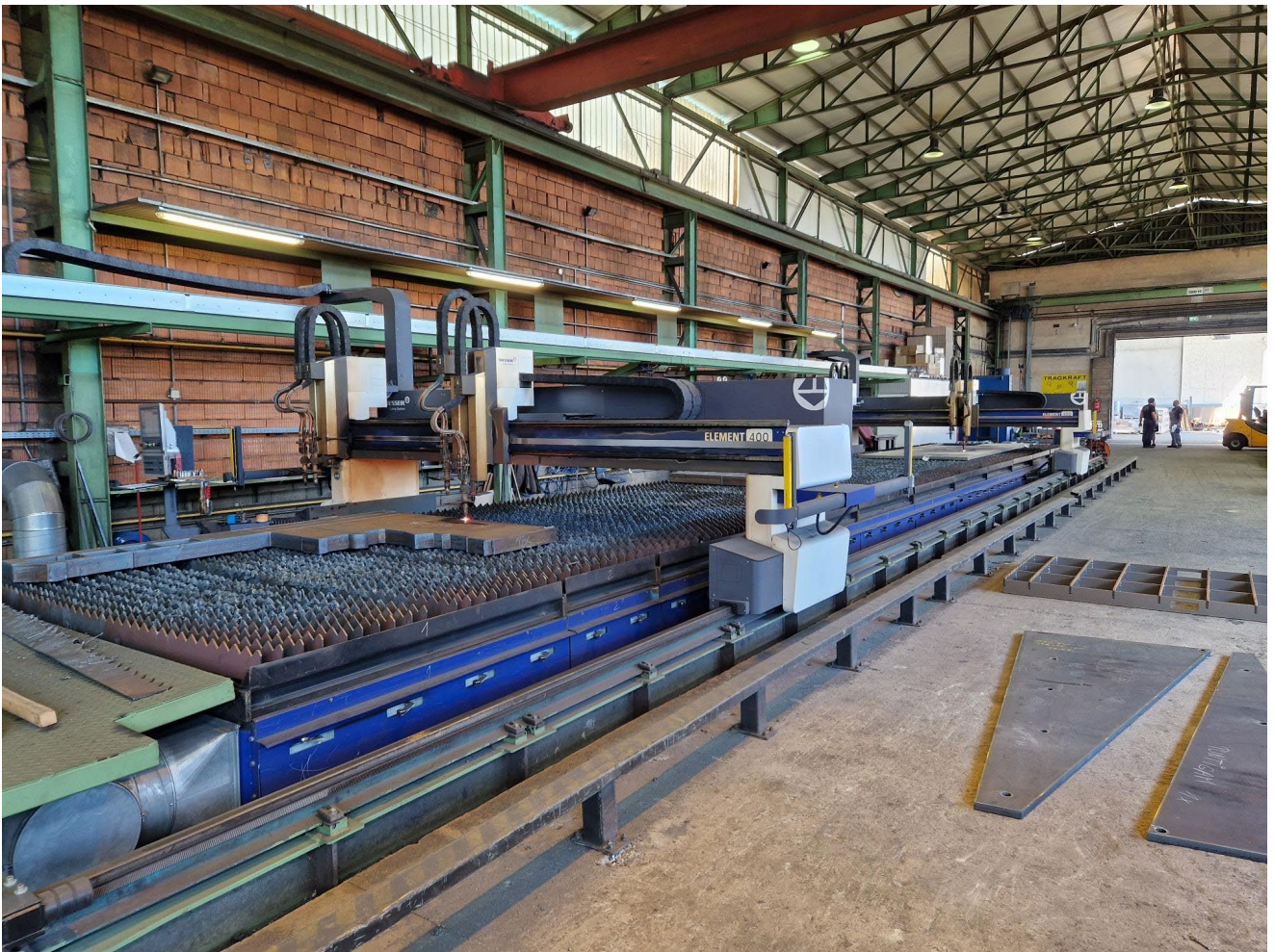
Bild 4: Zwei ELEMENT-Maschinen mit je 4 x ALFA-Autogenbrennern auf einer Laufbahn.
