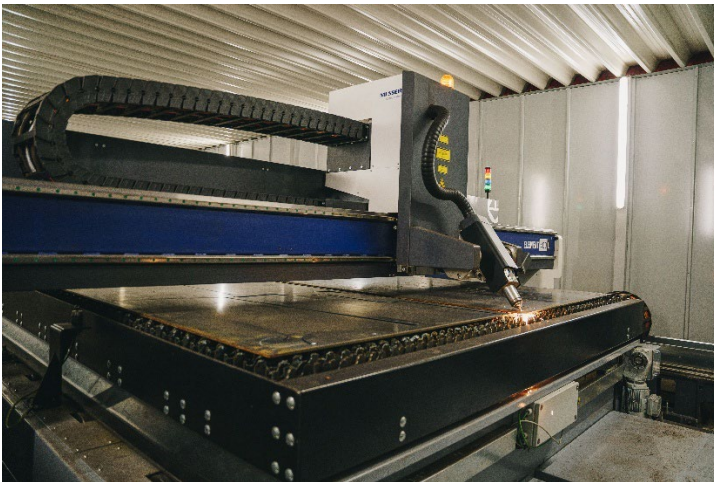
Foto 1: Die Lasermaschine ELEMENT L punktet mit hoher Dynamik, neuester Lasertechnologie und der Fähigkeit, XXL-Bleche wirtschaftlich zu bearbeiten.
