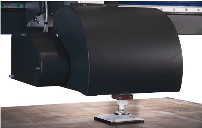
Foto 3: Die ELEMENT Plattform bietet zahlreiche Möglichkeiten zur Hochgeschwindigkeitsmarkierung verschiedener Materialien.
