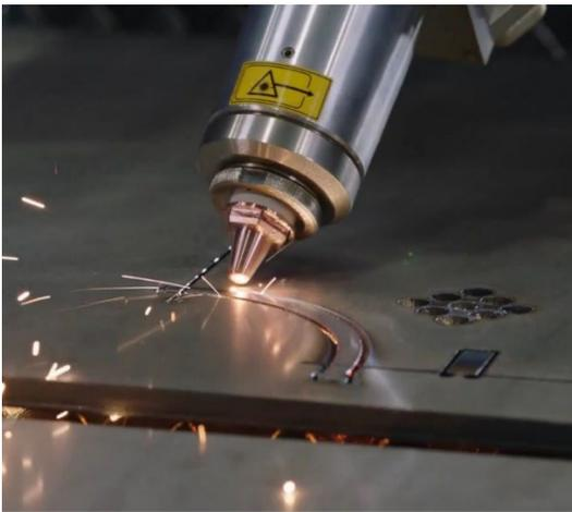
1. Das Bevel-U Fasenaggregat der ELEMENT L Laserschneidanlage liefert auch bei Materialdicken von 50 mm verschiedenste Fasenkonturen in bester und normgerechter Schneidqualität ab.
