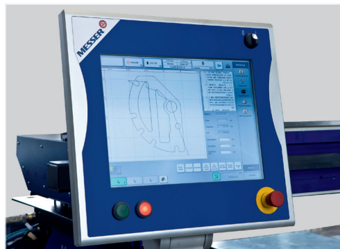
Die benutzerfreundliche Steuerung Global Control ermöglicht schnelles Einrichten und reduziert Fehlerquellen und Nebenzeiten.
