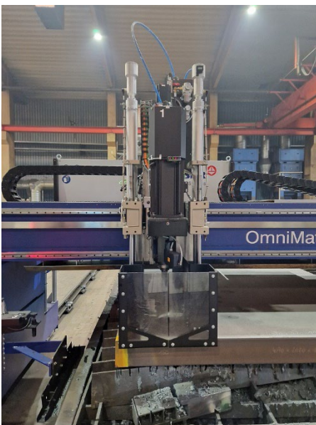
Bild 2: Mit dem Bohraggregat können jetzt Startlöcher problemlos vorgebohrt und kleinste Konturen auch in dickem Material geschnitten werden. © Messer Cutting Systems
