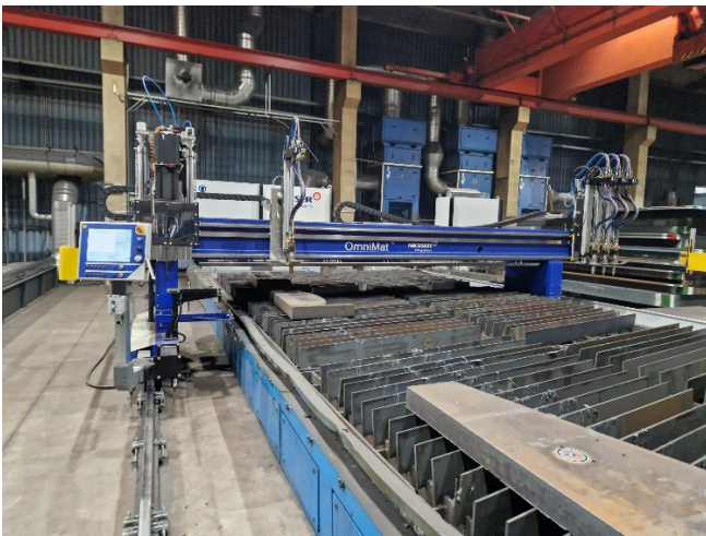
Bild 1: Die OmniMat® ist mit vier ALFA-Autogenbrennern und einem Bohraggregat inklusive 3-fach Wechsler ausgestattet. © Messer Cutting Systems
